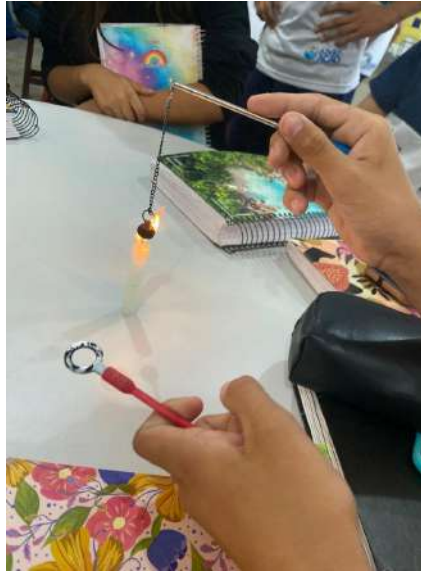
Figura 5.16: Experimento de dilatação volumétrica sendo realizado e observado por estudantes.
