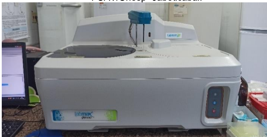
Figura 27 - Analisador bioquímico automático LabMax Plenno, no Laboratório de Patologia Clínica Veterinária do Hospital Veterinário Governador Laudo Natel – FCAV/Unesp- Jaboticabal.
