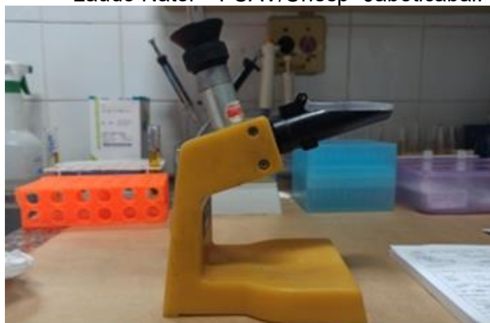
Figura 12 - Refratômetro utilizado para quantificação da proteína no material, no Laboratório de Patologia Clínica Veterinária do Hospital Veterinário Governador Laudo Natel – FCAV/Unesp- Jaboticabal.
