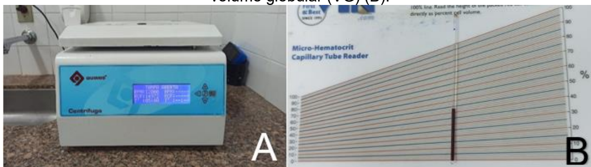
Figura 10 - Centrífuga utilizada para rodar os capilares (A). Régua para leitura do volume globular (VG) (B).
