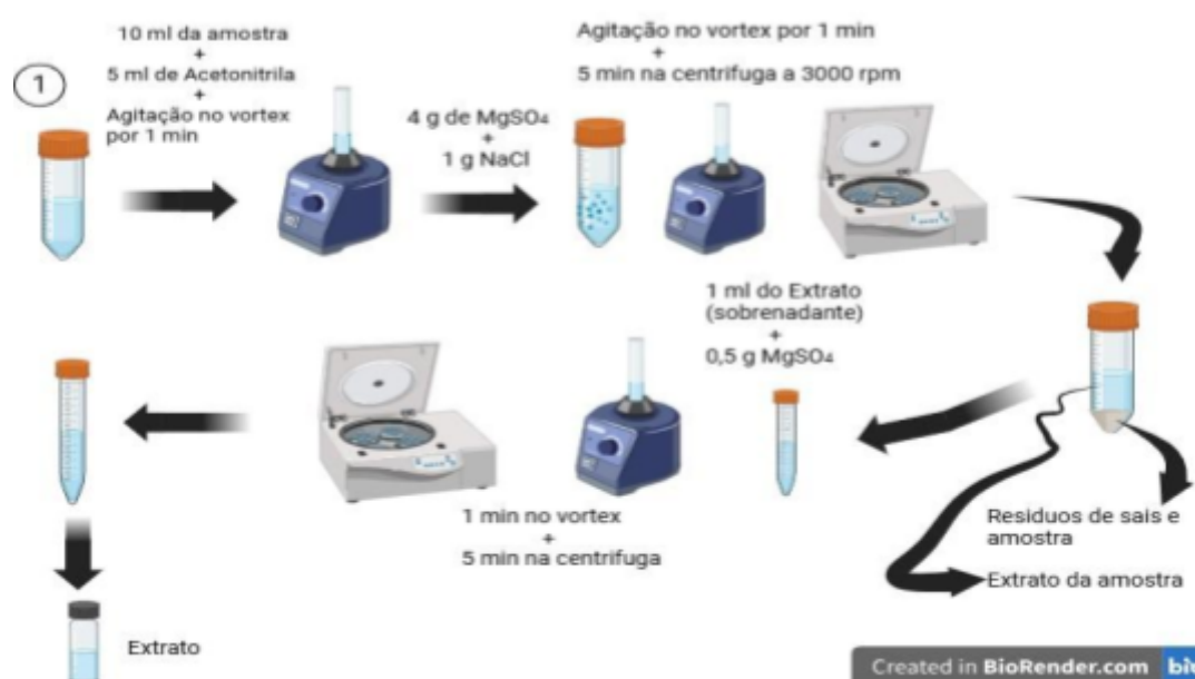
Figura 5 – Ilustração do procedimento de extração da amostra pelo método QuEChERS adaptado
