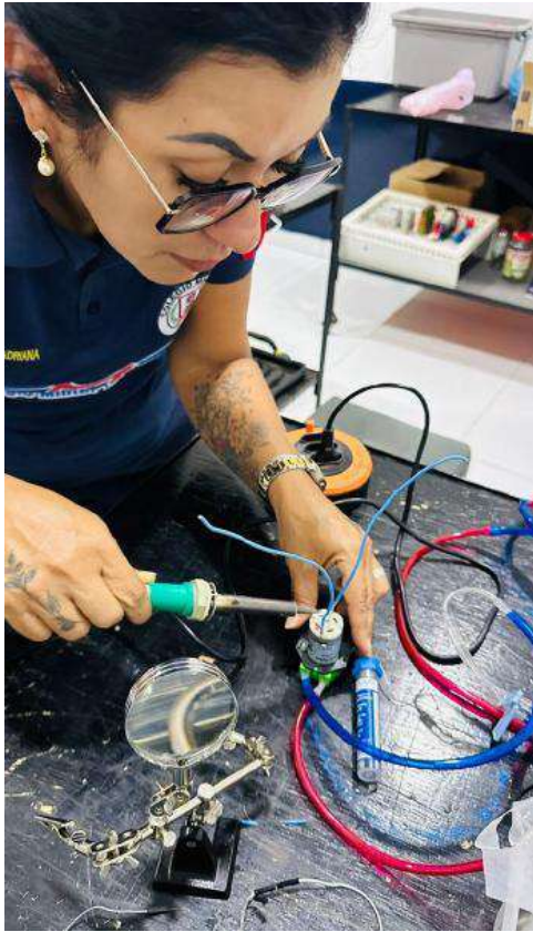
a) Montagem no laboratório do circuito eletrônico
