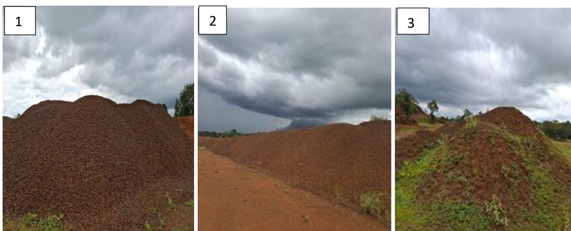
Figura 10 – Minério de ferro em três granulometrias diferentes: granulado (1), hematitinha (2) e rejeito (3).
