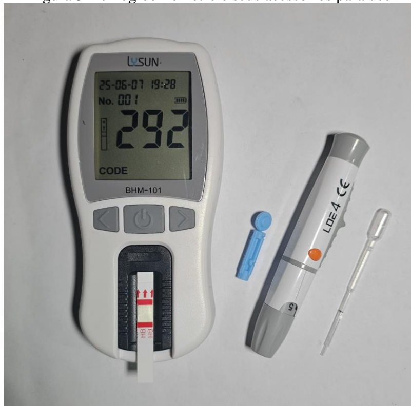
Figura 3 Hemoglobinômetro e seus acessórios para uso
