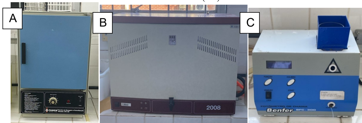
A: Estufa FANEM 315 SE; B: Banho-maria Grant 2008; C: Fotômetro de chama Benfer BFC-300. Fonte: Acervo do autor, 2025.
