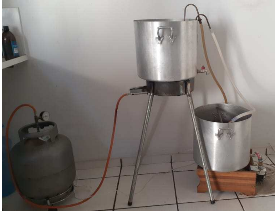
Figura 8 - Processo de mosturação e seus equipamentos
