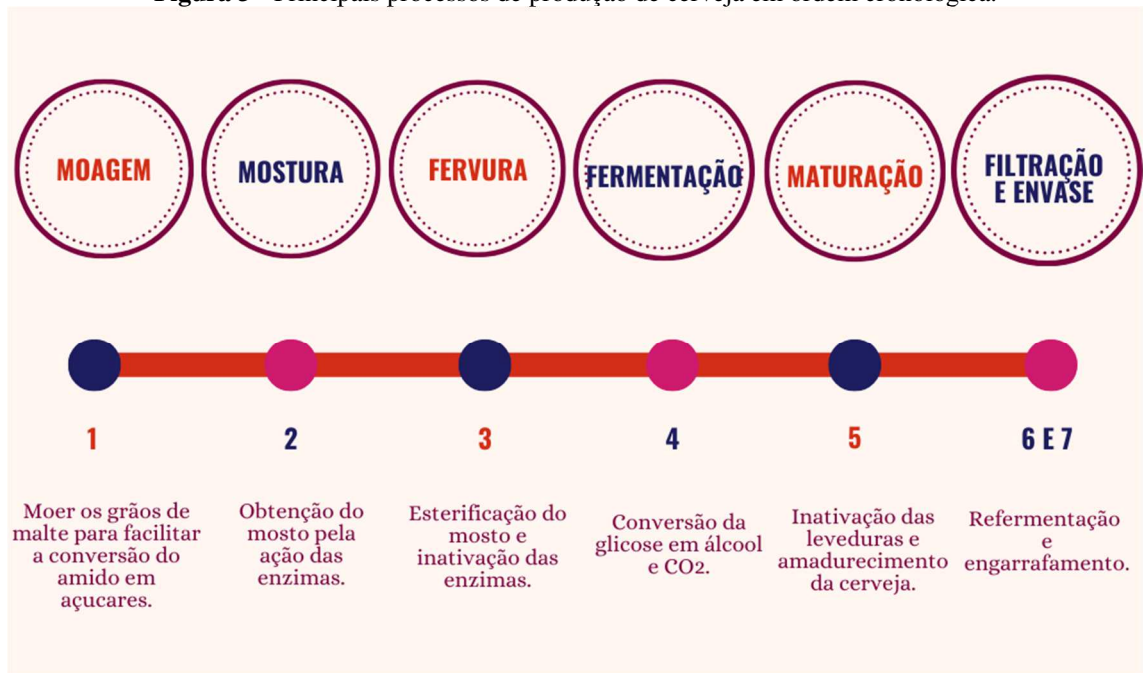
Figura 3 - Principais processos de produção de cerveja em ordem cronológica.
