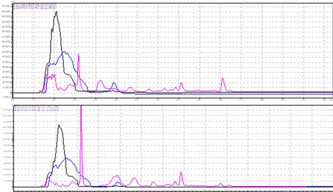
Figura 28 - Cromatogramas sobrepostos das cervejas em fração aquosa. Em preto cerveja fermentada por kefir em temperatura controlada, rosa em temperatura ambiente e azul cerveja convencional. A primeira em 220 nm e a segunda em 274 nm.
