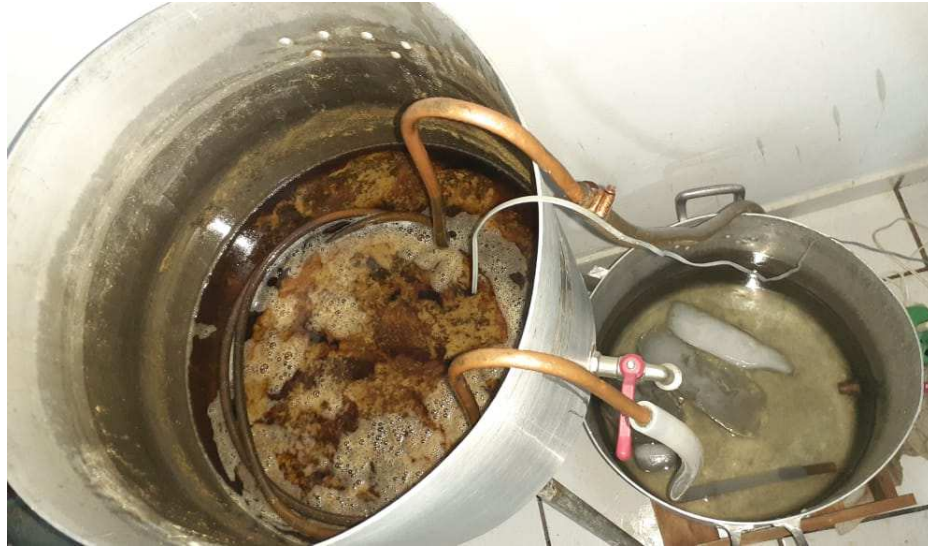
Figura 10 - Resfriamento do mosto
