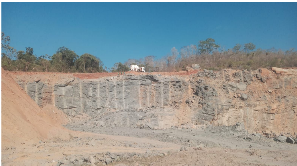
Figura 2- Preparação para a detonação da rocha
