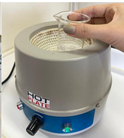
Figura 9: Manta aquecedora, processo de evaporação do hexano
