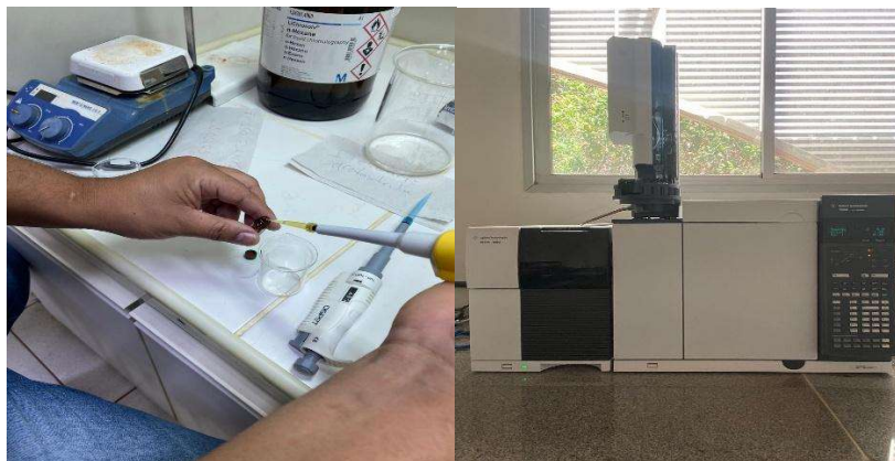
Figura 7 - Preparação da amostra para injeção e Cromatógrafo.
