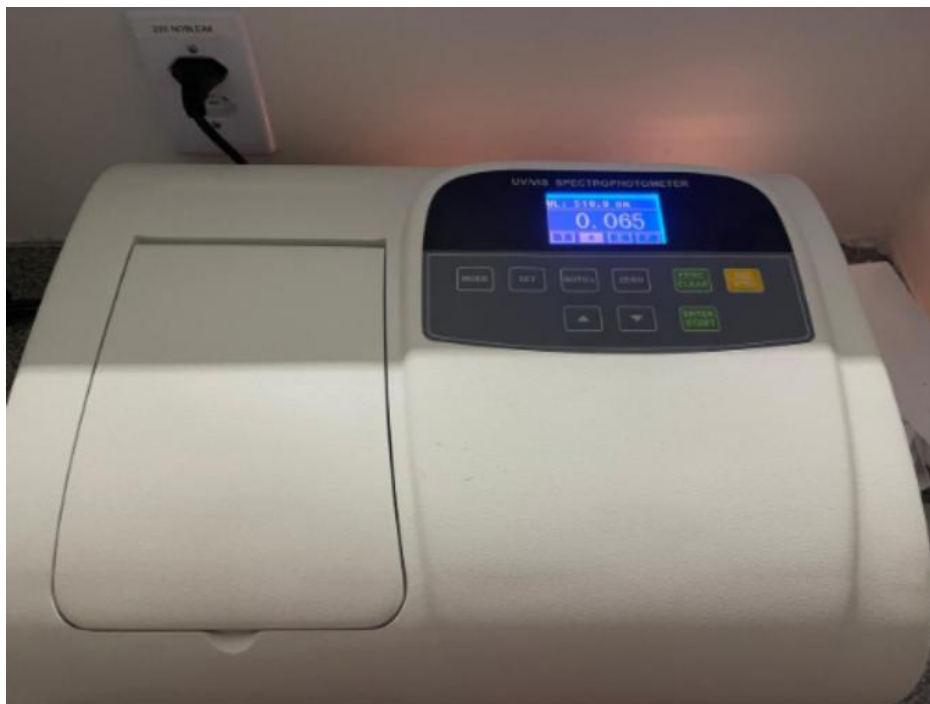
Figura 12 – Espectrofotômetro operando no modo absorvância a 510 nm.
