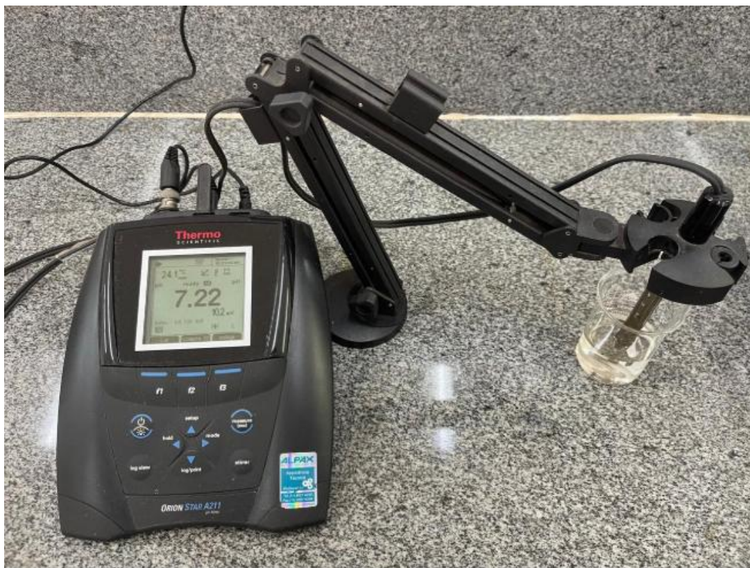
Figura 14 – Aferição de pH nas amostras de água.
