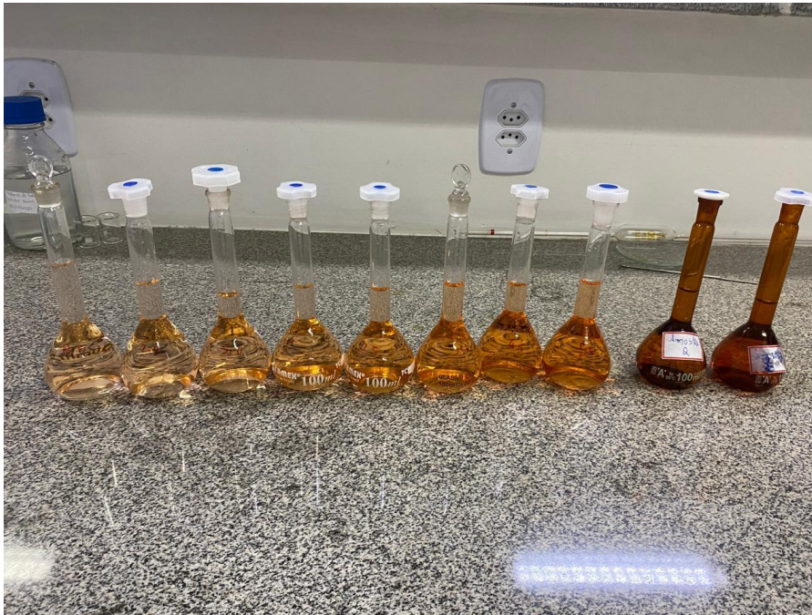
Figura 11 – Amostras e soluções padrão preparadas para leitura no espectrofotômetro.
