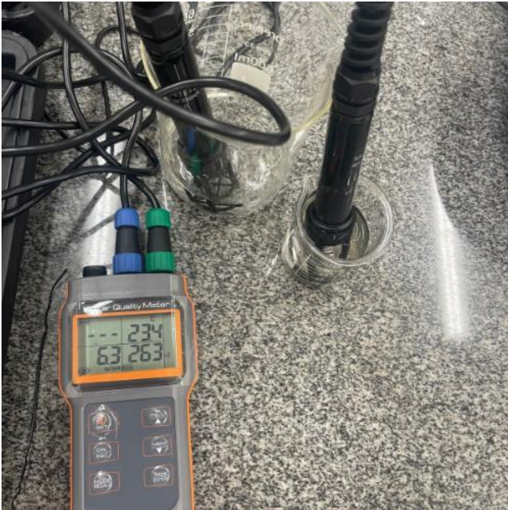
Figura 13 – Aferição de CE e OD nas amostras de água.
