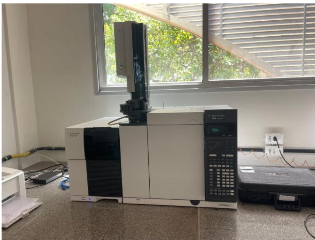
Figura 17 – CG/EM utilizado para verificação de contaminantes orgânicos.
