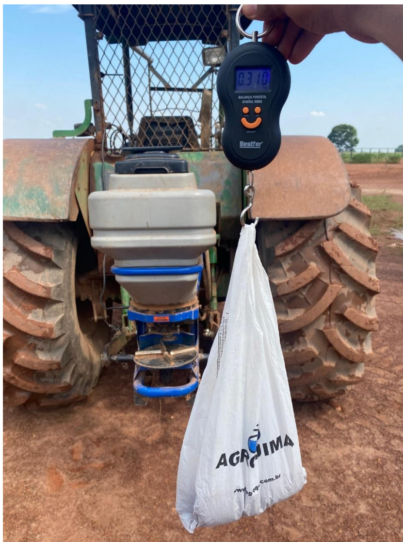
Figura 6 – Regulagem da taxa de semeadura da semeadeira elétrica A3.
