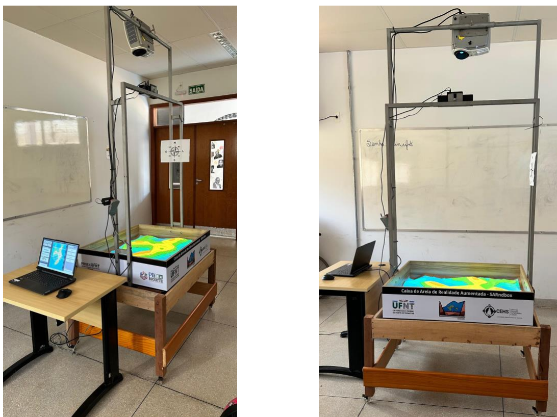
Figura 11 - Estrutura em MDF da Caixa de Areia de Realidade Aumentada.
