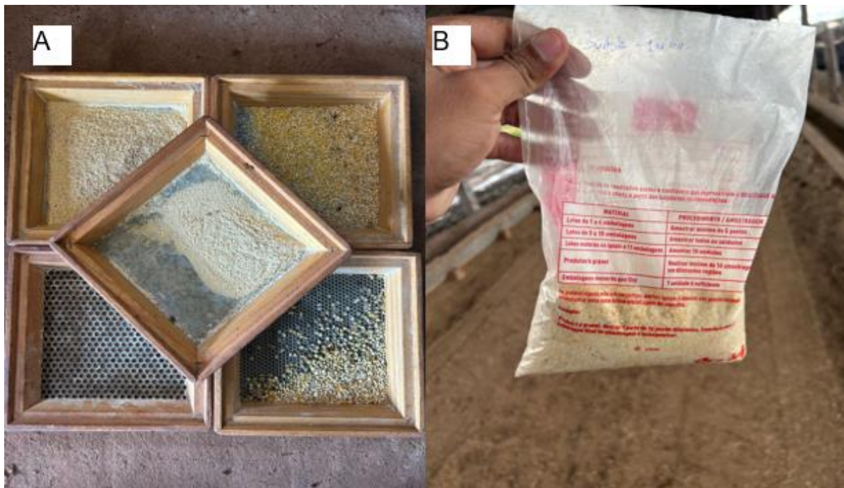
Figura 15 - Etapas para obtenção dos dados de granulometria do milho da Fazenda Alexandria, Santa Isabel do Pará – PA. A: Peneiras utilizadas no teste de granulometria; B: Amostra coletada de milho para avaliação
