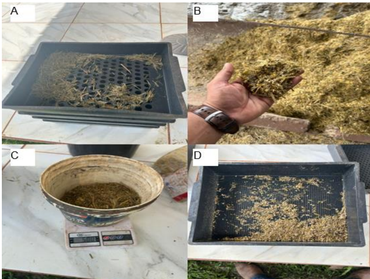
Figura 16 - Teste da Penn State, Santa Izabel do Pará – PA. A: Peneira de maior abertura; B: Coleta de material direto no cocho após distribuição; C: Pesagem e padronização da amostra para o teste da Penn State; D: Peneira de menor abertura
