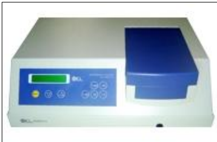
Figura 14 - Modelo do Espectrofotômetro UV/Vis utilizado na análise
