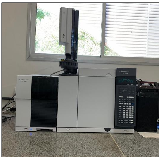
Figura 20 - Cromatógrafo a gás acoplado ao espectrômetro de massas (GC-MS) utilizado nas análises
