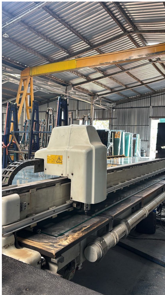
Figura 1 – Execução do processo de corte das chapas de vidro
