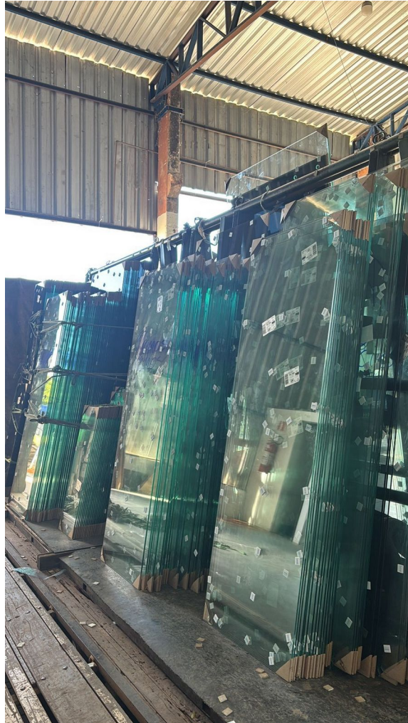
Figura 5 – Carregamento dos vidros temperados para transporte
