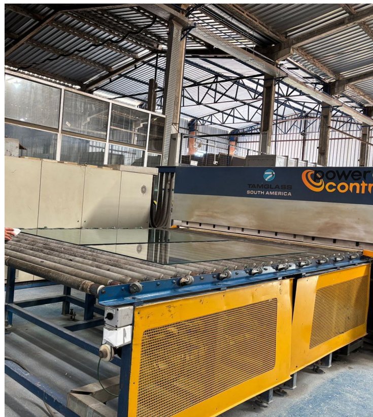
Figura 3 – Forno industrial utilizado no processo de têmpera do vidro
