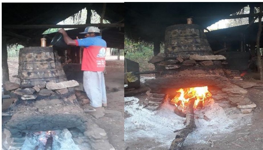
Figura 8 - Alambique em cima da fornalha para ferver a garapa azeda.
