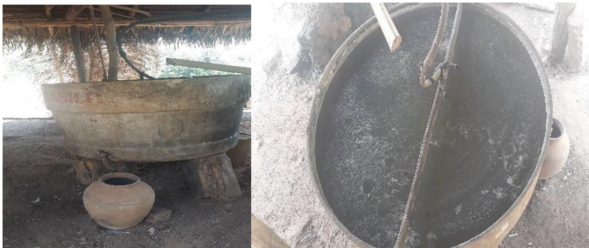
Figura 13 - Serpentina cheia de água e o pote de barro onde caia a pinga
