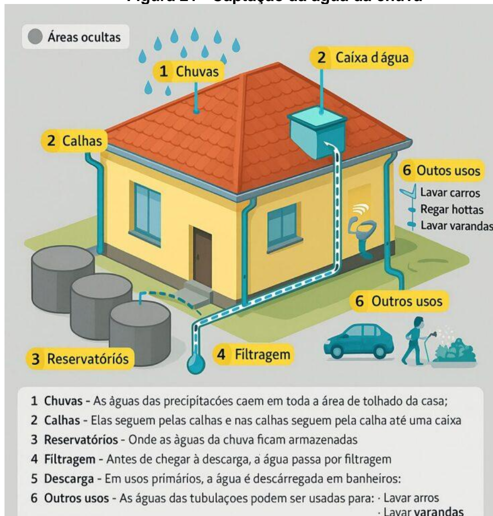
Figura 21 - Captação da água da chuva
