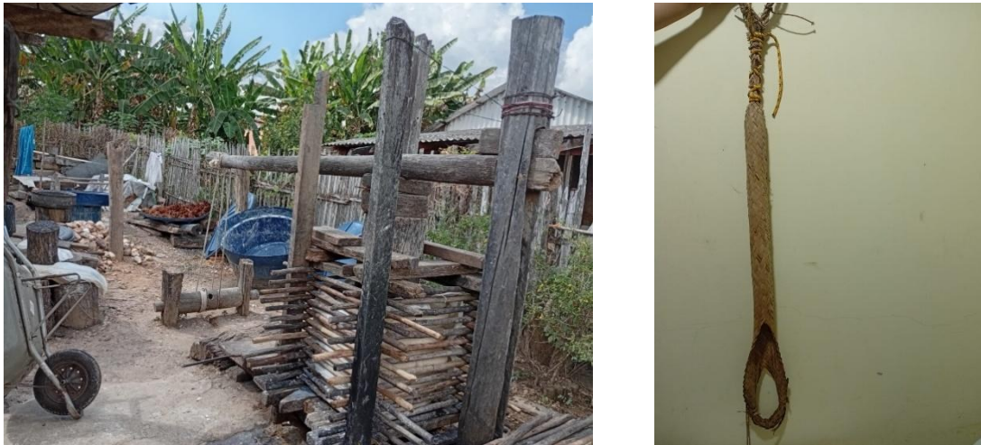
Figura 7 – Equipamento prensa mecânica de fuso (à esquerda) e tipiti (à direita)
